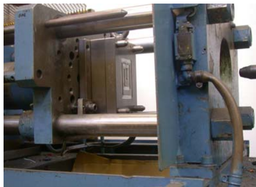
Fig.7 Molde para fabricar un clip de plástico para papel
