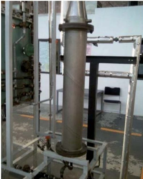
Figura 1. Extractor de aceites esenciales antes del acondicionamiento.
